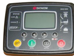
Панель управления DATAKOM
